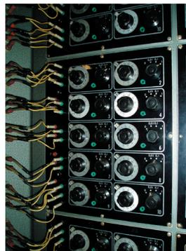
*Une partie des potentiomètres d'affichage des coefficients de calcul*
