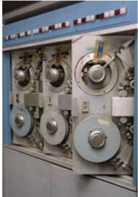
*Mécanisme de bandes du Gamma 30*
