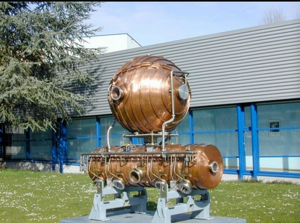
**Cavités radiofréquence en cuivre du LEP
