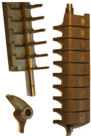
Touches en Zamak avec inclusion d'acier
