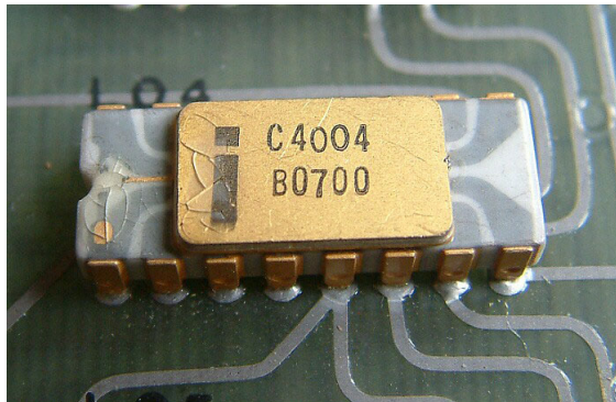
Intel 4004 (1970) boîtier DIL céramique : 20,3 × 7,6 mm
