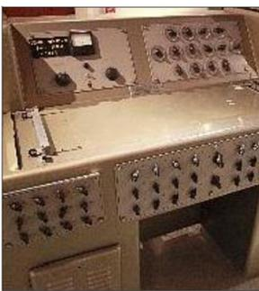
l'aide au diagnostic en pathologie neurologique dans les années 50. Sur le pupitre en acier se déroulait le papier d'enregistrement des données obtenues depuis les capteurs placés sur la tête des patients. Une technique parfaitement indolore.
