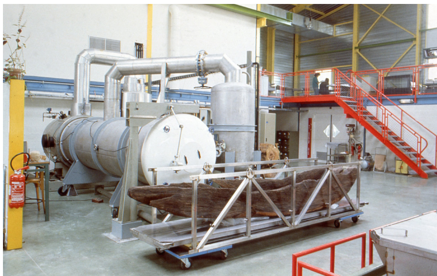
La pirogue de Charavines-Colletière, datée du XIV e siècle, après séchage par lyophilisation. Photo d'archives ARC-Nucléart
