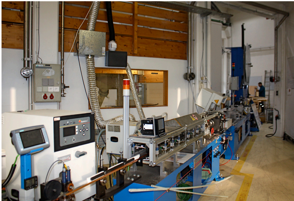
Banc de production du câble de l'aimant hybride du Laboratoire national des champs magnétiques intenses. Photo ACONIT
