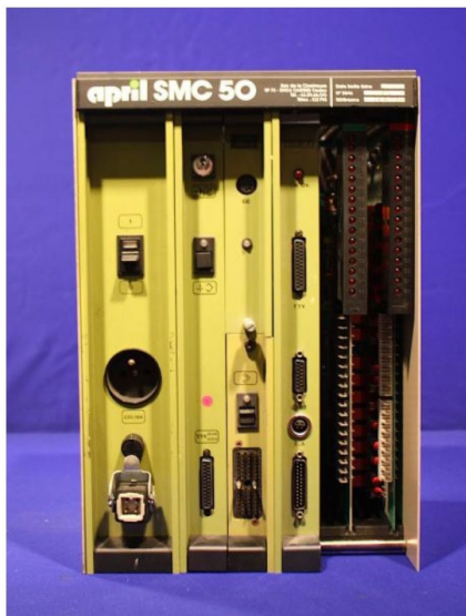
De la cellule de base Silimog à l'automate industriel programmable SMC 50 produit par Renault-automation et diffusé par la société April, en passant par la console de programmation PB 2062 de chez Merlin Gerin. Photos ACONIT
