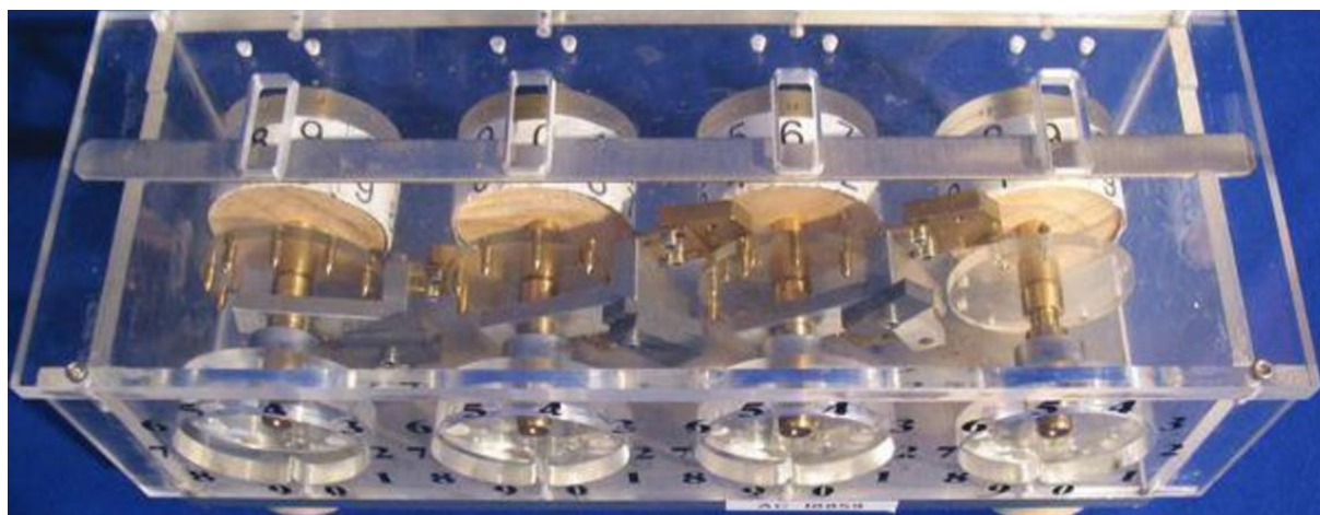
Maquette du mécanisme interne de la Pascaline. Collection et photo ACONIT
