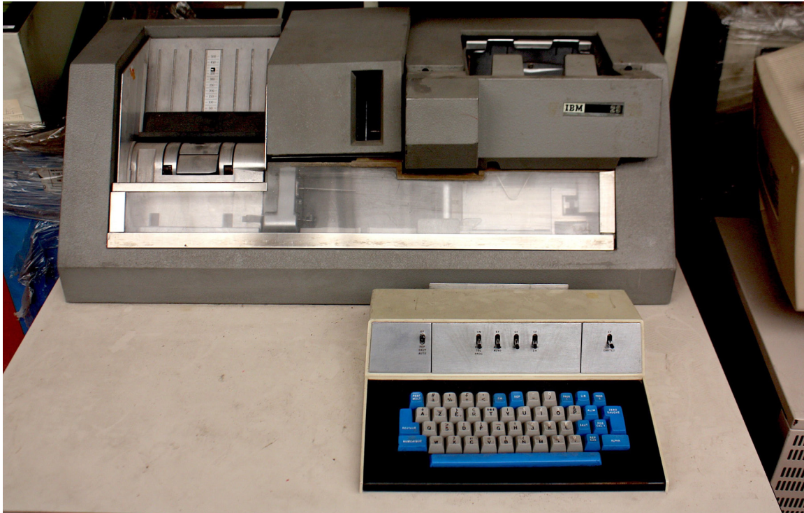
Apparence générale de la perforatrice IBM 29 avant remise en état. Photo ACONIT
